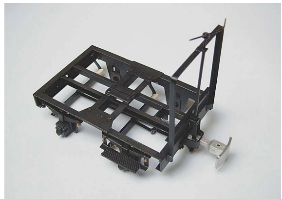
Ausführung mit Bremse (zur besseren Demonstration ohne Räder/Achsen)
