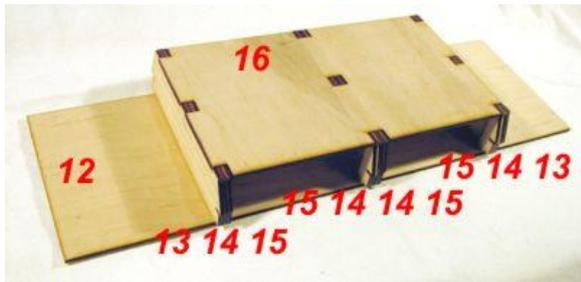
Dazu dienen 3 verschiedenartige Spanten (13, 14, 15), die wie in der folgenden Abbildung in Sandwichbauweise zusammen verklebt und in die Grundplatte (12) eingesetzt werden. Darauf kommt dann die Bodenplatte (16) des Staukastens. Achten Sie beim Einkleben der Spantenpakete wieder auf Rechtwinkligkeit.
