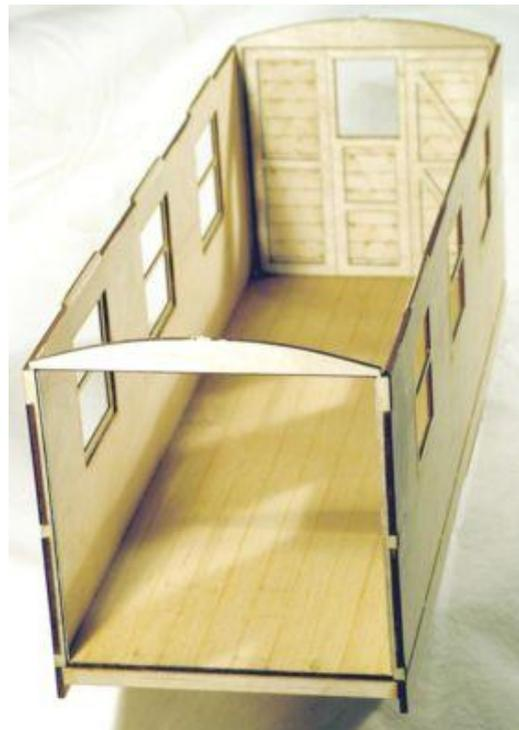
Die Türrahmen werden nun stirnseitig in den Wagenkasten eingeklebt. Wenn Sie nun die oberen Zinken der Seitenwände (2) innen noch etwas anschrägen, sollte sich das Dach passgenau aufsetzen lassen.
